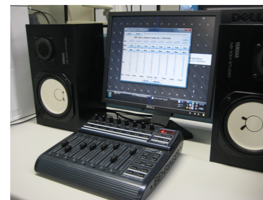
図3 ハードウェアと組み合わせた楽器音イコライザシステム
